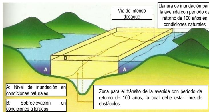
Figura 6-14. Llanura de inundaciones en condiciones naturales (A) y sobreelevación en condiciones alteradas (B: la diferencia de niveles no debe superar 30 cm y la de velocidades no mayor a 10%) para la avenida de 100 años de período de retorno. Adaptado de Godesky (2006).
