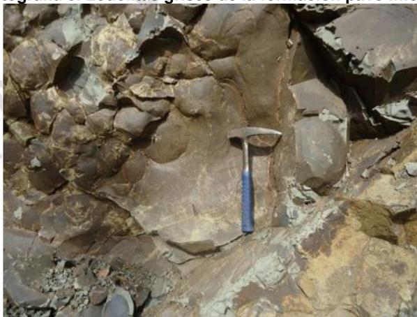
Nota: Donde se observa partición concoidea atribuida a silicificación o cementación calcárea muy fuerte, que le otorga la dureza o competencia a este tipo de roca, dando como resultado expresiones topográficas muy fuertes.
