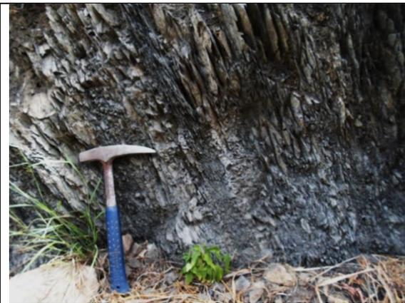
Figura 22. Macizo rocoso de las litoarenitas, limolitas y lodolitas de Urrao (K2alu), muy fracturado, plegado, con bloques pequeños angulosos formados por intersecciones de familias de discontinuidades, persistencia de esquistosidad, estación JAM-19, vía Nacional Medellín - Turbo, municipio de Dabeiba, vereda El Pital, coordenadas (1105758.5E - 1248007.7N).
