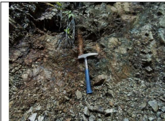
Figura 24. Macizo rocoso de los Basaltos de El Botón, muy fracturado, con bloques pequeños angulosos formados por intersecciones de familias de discontinuidades, parcialmente alterado, estación JAM-28, vía Nacional Medellín – Turbo, municipio de Frontino, vereda El Llano, coordenadas (1092264.9E - 1242571.3N).
