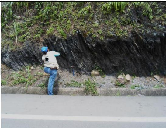
Figura 23. Disposición del macizo rocoso de las litoarenitas, limolitas y lodolitas de Urrao (K2alu), muy fracturado presente en la estación JAM-19, vía Nacional Medellín - Turbo, municipio de Dabeiba, vereda El Pital, coordenadas (1105758.5E - 1248007.7N).
