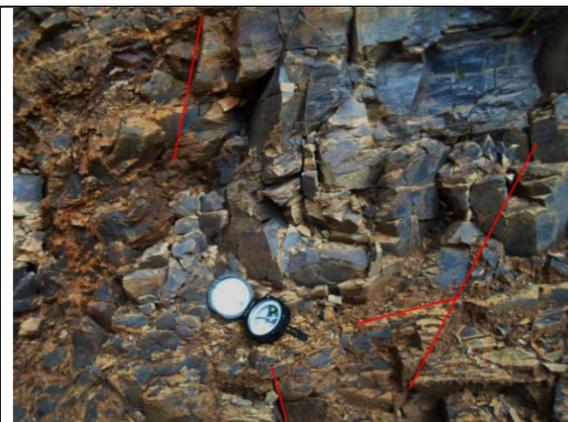
Figura 20. Macizo de las litoarenitas, limolitas y lodolitas de Urrao (K2alu), parcialmente alterado, entrabado, con bloques de varias caras angulares, estación JAM-07, vereda Cestillal, municipio de Cañasgordas, (1110663.9E - 1250219.8N).
