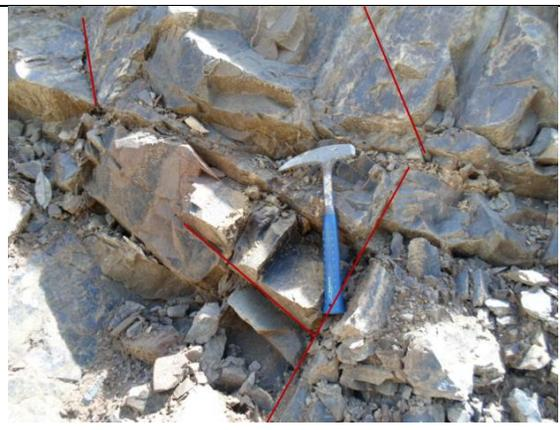
Figura 19. Discontinuidades presentes en el macizo rocoso de las litoarenitas, limolitas y lodolitas de Urrao (K2alu), sin alterar, entrabadas, estación JAM-03, vía Nacional Medellín – Turbo, municipio de Cañasgordas, vereda Cirigüan, coordenadas (1232728.4E - 1121853.7N)
