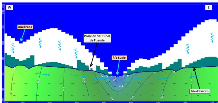
Figura 58. Nivel freático en un corte transversal en la localización del túnel de Fuemia.
