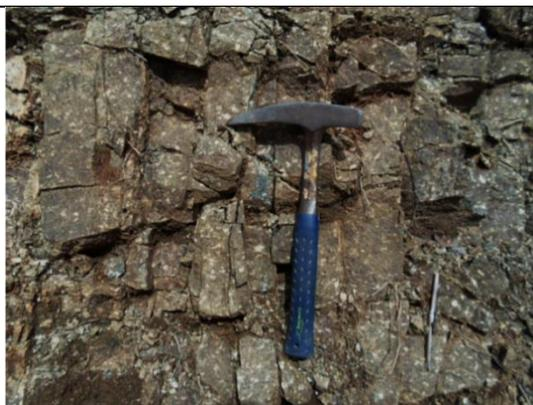
Figura 25. Macizo rocoso de los derrames diabásicos y basálticos de los Basaltos de El Botón, muy fracturado, con bloques angulosos formados por intersecciones de familias de discontinuidades, estación JAM-28, vía Nacional Medellín – Turbo, municipio de Frontino, vereda El Llano, coordenadas (1092264.9E - 1242571.3N).
