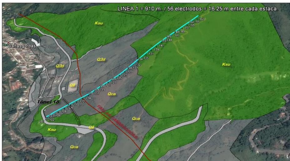
Figura 28. Localización de la Línea de Geoeléctrica Continua. G-1, Túnel 18, tomado de (CONSORCIO ANTIOQUIA DEL MAR.- HIDROGEOCOL S. A., 2016).
