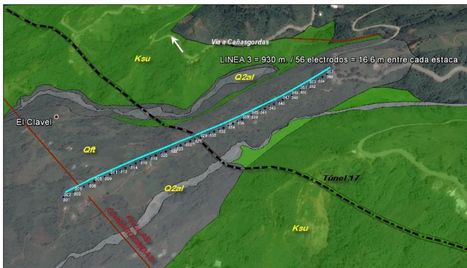
Figura 34. Localización de la Línea de Geoeléctrica Continua. G-3, Túnel 17 (El Toyo).
