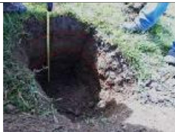
Figura 74. Apique de 1.5X0.5m realizado sobre suelo residual arcilloarenoso de la unidad Srs2K2alu, estación JAM-03, vía Nacional Medellín – Turbo, municipio de Cañasgordas, vereda Cirigüan, coordenadas (1232728.4E – 1121853.7N).
