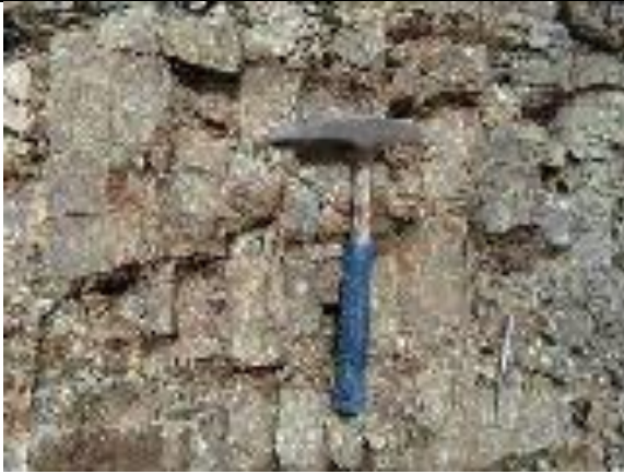
Figura 29. Detalle de los Basaltos de El Botón, muy fracturado, con bloques angulosos formados por intersecciones de familias de discontinuidades, estación JAM-28, vía Nutibara – Murri, municipio de Frontino, vereda El Llano, coordenadas (1092264.9E - 1242571.3N). Elaboración propia.
