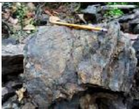
Figura 92. Milonita de falla presentes en el macizo rocoso de las litoarenitas, limolitas y lodolitas de Urrao (K2alu), estación GJAM-16, vía Uramita-Junta de Uramita, municipio de Uramita, vereda Santo Domingo, coordenadas (1111954.9 E - 1255576.7 N)
