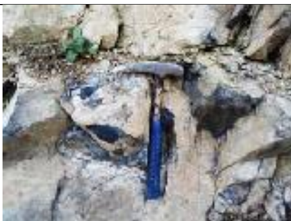
Figura 22. Detalles de capas de lodolitas muy fracturadas de la Formación Urrao (K2alu), aflorantes en la vereda Camparrusia. Estación JAM-51, municipio de Dabeiba, coordenadas (1115105.7E - 1266055N). R:S0W; B:S. Elaboración propia.
