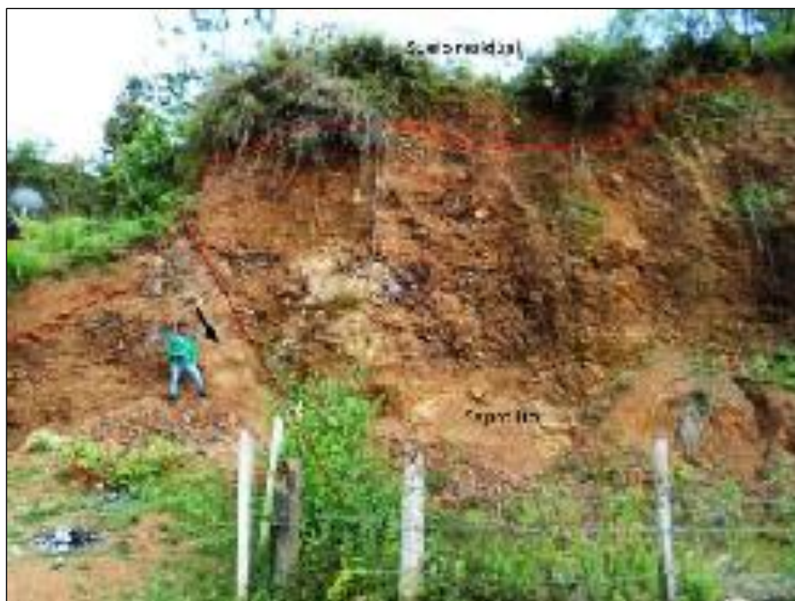
Figura 119. Afloramiento fallado de suelo residual de material parental sedimentario (Srs2) de la Formación Litoarenitas, limolitas y lodolitas de Urrao (K2alu), en donde se observa los perfiles de meteorización de Deere & Patton (1971) y Dearman (1974, 1991), en los cuales considera como suelo a los horizontes VI (suelo residual), V (roca completamente meteorizada o descompuesta, saprolito fino) y IV (roca altamente meteorizada o descompuesta, saprolito grueso).
