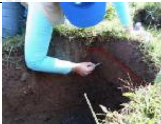
Figura 75. Suelo residual arcilloarenoso o de la unidad Srs2K2alu, estación JAM-03. Prueba con penetrómetro Vía Nacional Medellín – Turbo, municipio de Cañasgordas, vereda Cirigüan (1232728.4E – 1121853.7N)
