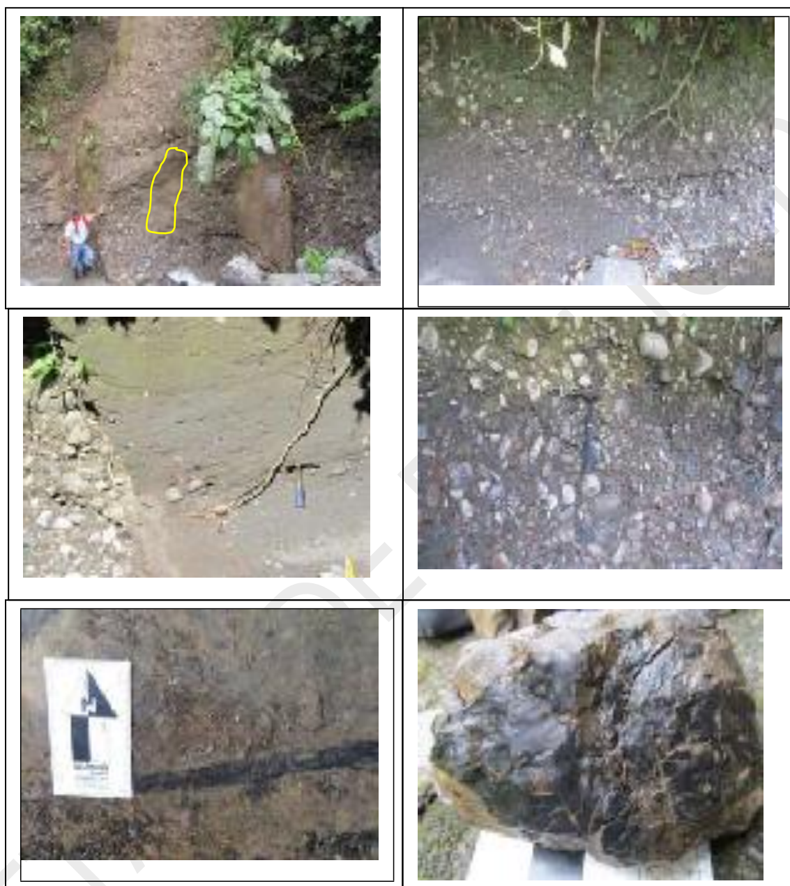
Figura 32. A). Intercalaciones de capas de arenitas con paquetes de conglomerados con lentes arenosos. B) Contacto gradacional de arenitas a conglomerados. C) Contacto neto entre capas. D). Aspecto general de los conglomerados. E) Lodolitas grises con guijos de chert y restos de carbón. F). Impresiones de hojas en capas de sublitoarenitas. Elaboración propia a partir de Rodríguez (2013)
