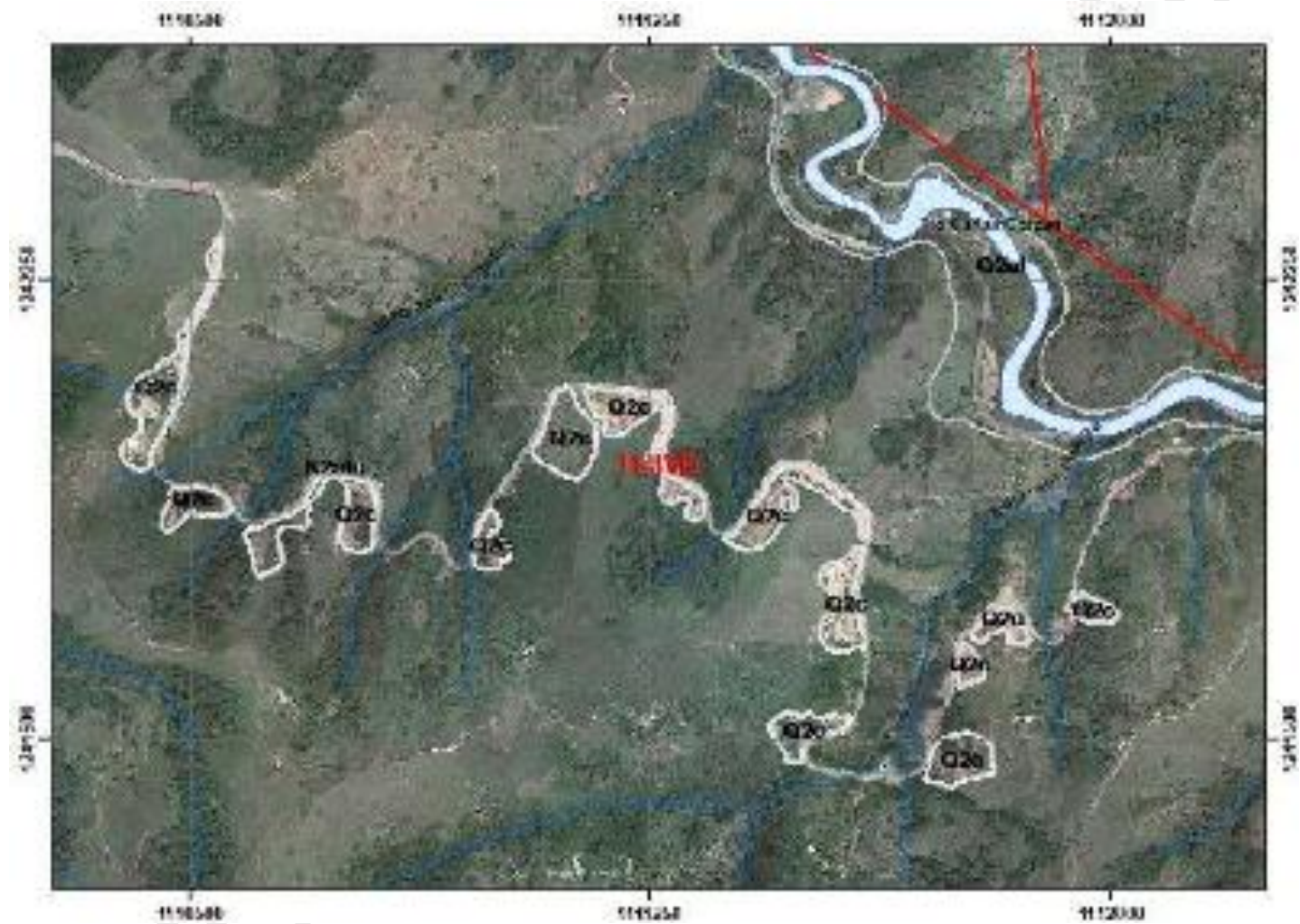
Figura 59. Falla de Cañasgordas que controla el flujo del Río del mismo nombre y el efecto de los depósitos coluviales a lo largo de la vía que conduce a Frontino. Elaboración propia.
