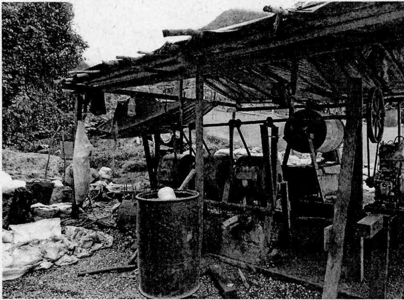
Nótese los molinos en serie, denominados cocos utilizados para la molienda del material pétreo o mina
