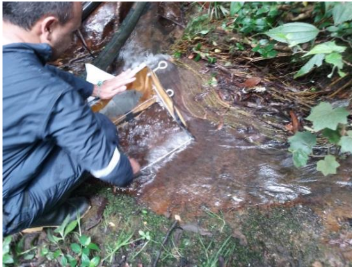
Figura 143. Toma de muestra de macroinvertebrados acuáticos con Red Surber –río Bogotá, antes de Villapinzón. Foto: Laboratorio Ambiental CAR 2017
