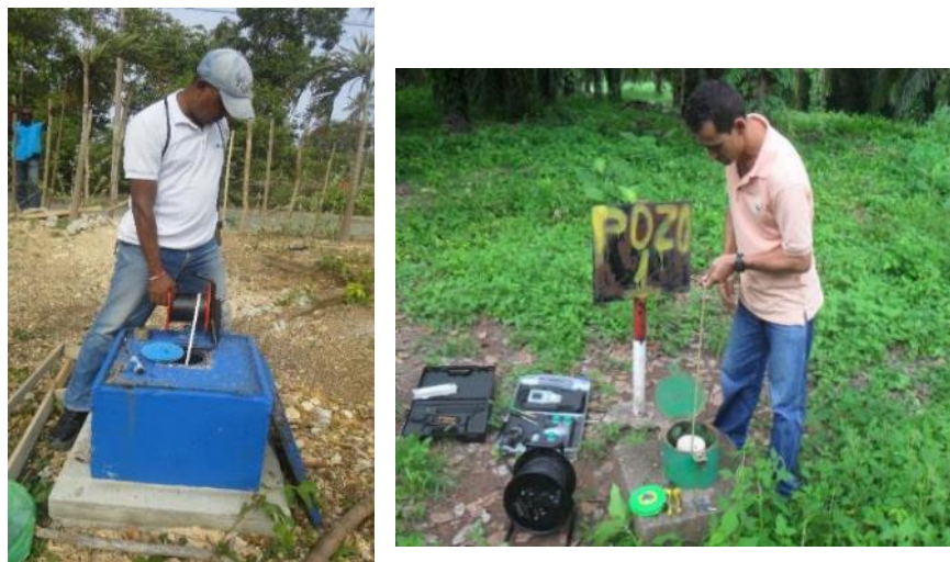
Figura 151. Toma de niveles en pozos profundos. Fuente: Izquierda: Coralina; derecha: Corpocesar.
