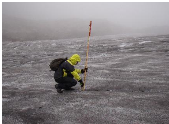
Figura 92. Captura de valores de espesor de nieve con el uso de una sonda para nieve. Fuente: Fotos de campañas de monitoreo de glaciares colombianos, IDEAM, 2012.
