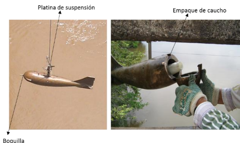
Figura 103. Integrador en Profundidad de Sedimento en Suspensión USD – 49. Izquierda. muestreador se sumerge en la corriente. Derecha. Muestreador es retirado para extraer la muestra. Fuente. Subdirección de hidrología. IDEAM.2017.
