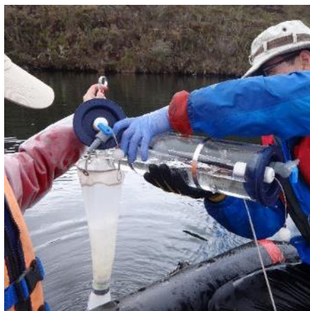
Figura 127. Concentración de muestra con botella Van Dorn y red de plancton. Fuente: Ángela
