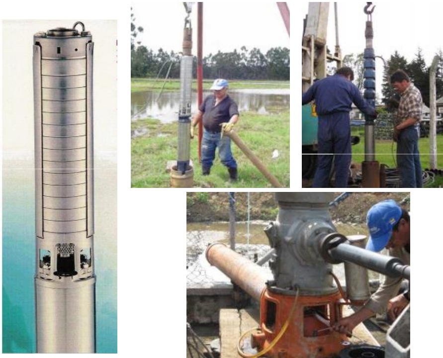
Figura 163. Bomba sumergible utilizada en pruebas de bombeo. Fuente: (Valencia Cuesta, s.f)
