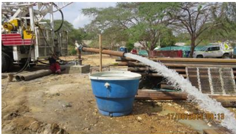
Figura 169. Prueba de Bombeo a Caudal Constante Pozo SGC Riohacha 2 (N: 1 765 265, E: 1 132 644). Fuente: (SGC, 2016).
