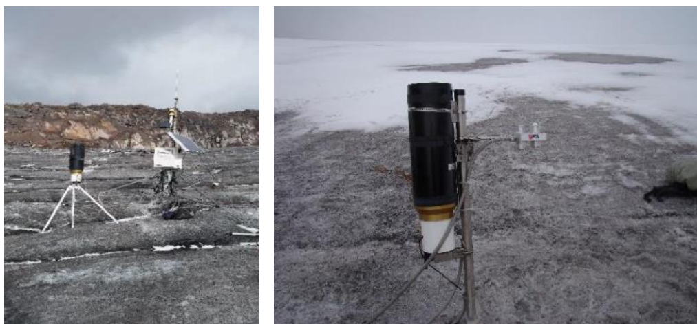
Figura 28. Pluviómetro EMMA instalado en el Parque Nacional Natural Los Nevados. Fuente: Fotos de campañas de monitoreo de glaciares colombianos, 2015. Archivo Grupo de Suelos y Tierras- Subdirección de Ecosistemas e Información Ambiental- IDEAM. .
