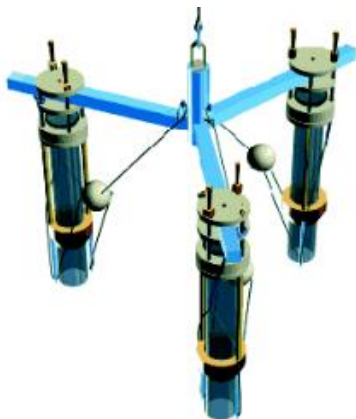
Figura 205. Multimuestreador de gravedad (Multicore Imagen tomada de UWITEC, 2017)
