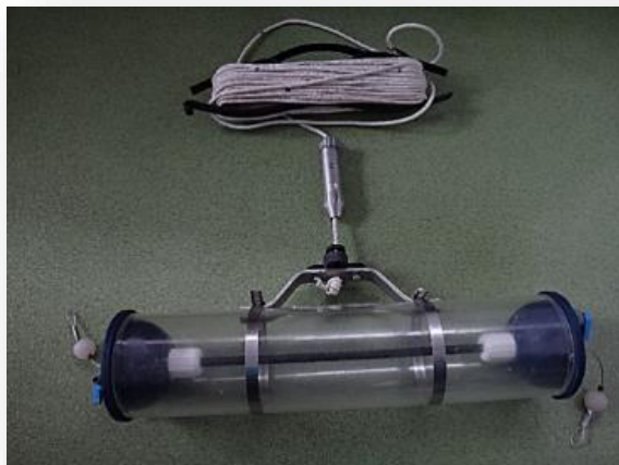
Figura 123. Botella muestreadora tipo Van Dorn horizontal para toma de muestras en profundidad.
