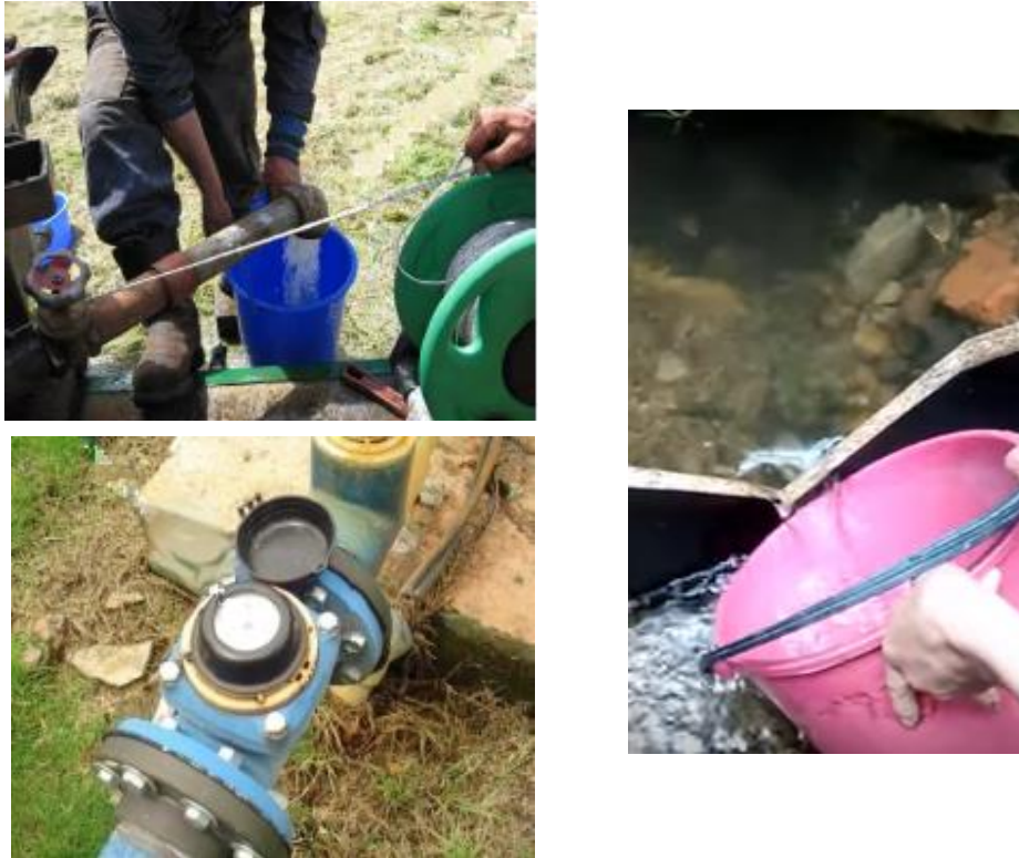
Figura 165. Izquierda: medición de caudales por métodos volumétricos de afloro y medidor de corriente Fuente: (Valencia Cuesta, s.f). Derecha: aforo de caudales pequeños. Fuente: https://www.youtube.com/watch?v=KqMdrmMu6Yo
