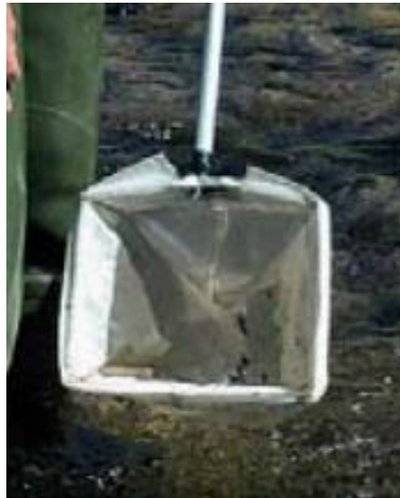
Figura 142. Red Rectangular. Foto. J. Alba-Tercedor. Tomada de Metodología para el establecimiento del Estado Ecológico según la Directiva Marco del Agua. Protocolos de muestreo y análisis para Invertebrados Bentónicos. 2005
