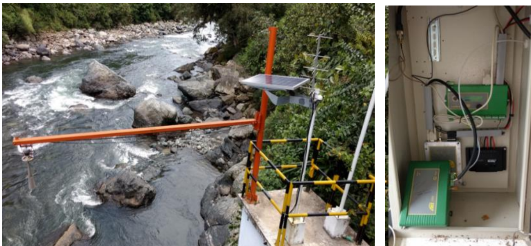
Figura 61. Izquierda. Estación satelital Pilispi, Derecha. Estación Automática San Juan. Área Operativa 7 IDEAM. Fuente IDEAM 2017.
