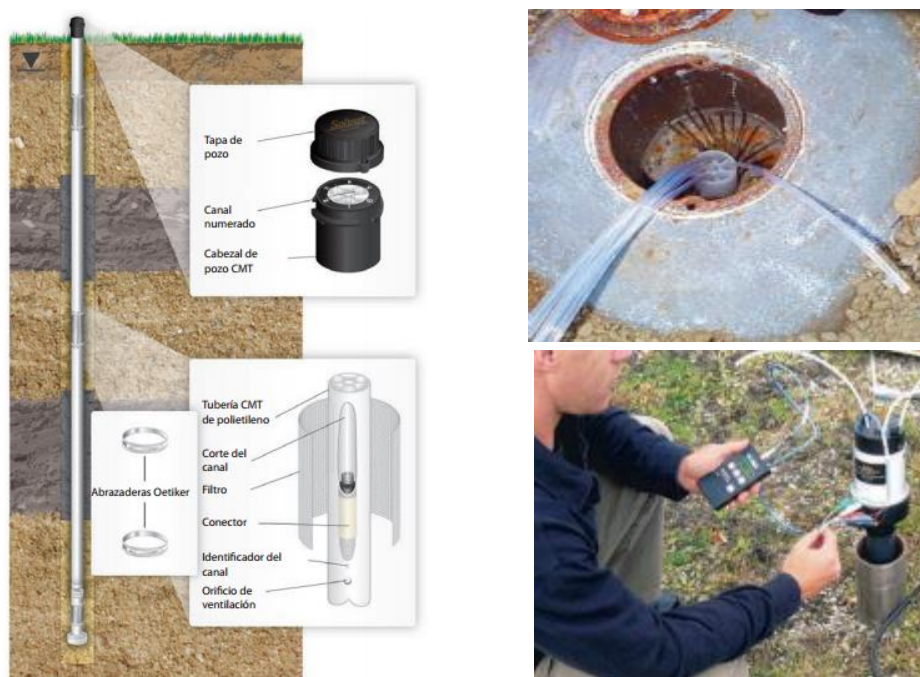
Figura 187. Muestreadores multinivel que permite el monitoreo de varias zonas en un sistema. Fuente: (Solinst, 2017b).
