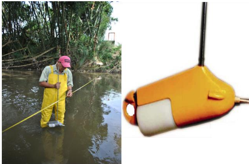
Figura 105. Muestreador para sedimentos en suspensión tipo USDH-48. Izquierda. Toma de muestra, estación Palo Gordo, corriente, río de Oro. Fuente. Subdirección de Hidrología. IDEAM.
