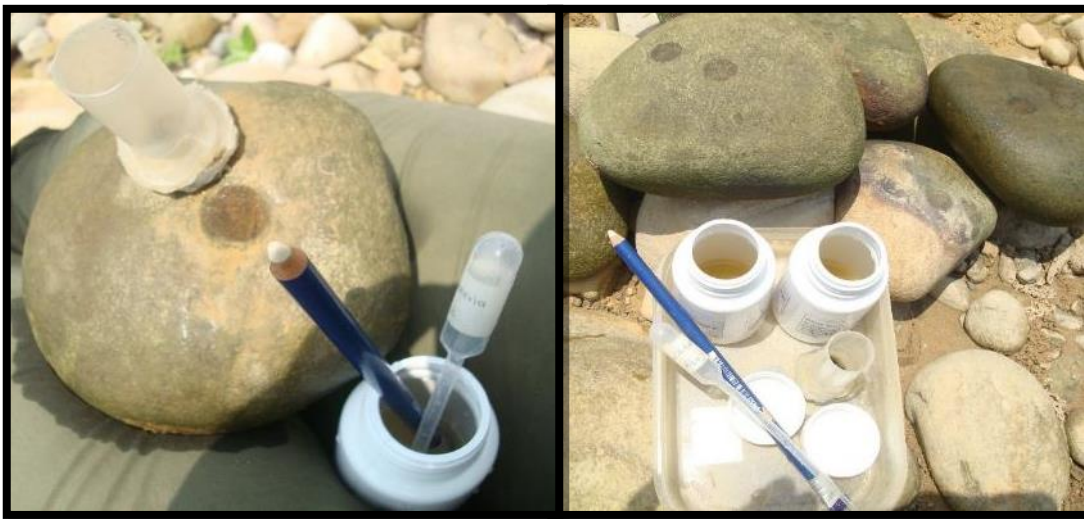
Figura 131. Elementos utilizados para el muestreo de algas perifíticas sobre sustratos duros.
