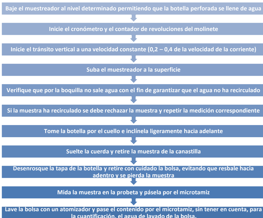
Figura 112. Procedimiento para realizar el aforo sólido integrado con bolsa plegable. Fuente, (EPAM S.A ESP, 2011)
