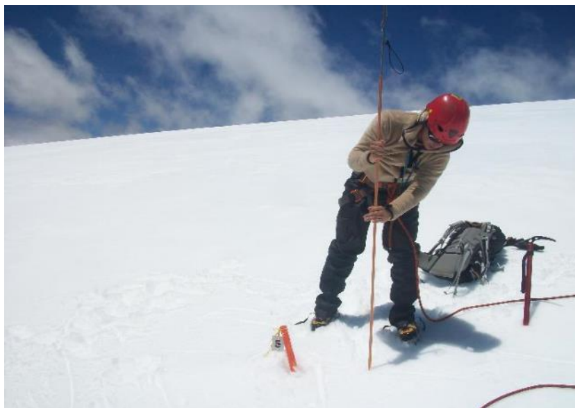
Figura 99. Captura de medición del espesor de la capa de nieve con el uso de una sonda. Fotos de campañas de monitoreo de glaciares colombianos, Sierra Nevada El Cocuy. IDEAM, 2012.
