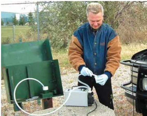
Figura 176. Ejemplo de uso de una bomba peristáltica Fuente: (Solinst, 2017c)
