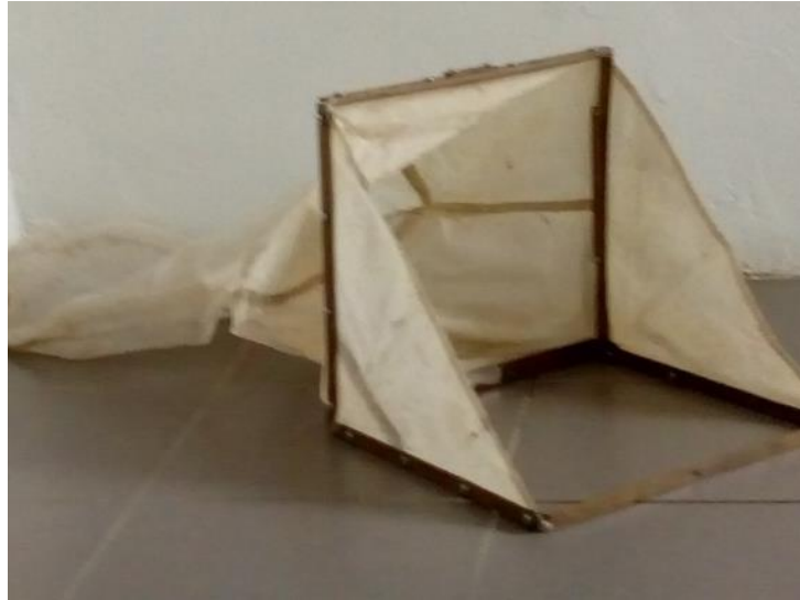
Figura 139. Red tipo Surber. Foto. Laboratorio de Calidad Ambiental IDEAM, 2017.
