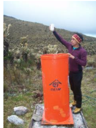
Figura 25. Procedimiento de vertimiento de la solución anticongelante dentro del pluviómetro totalizador de nieve del IDEAM ubicado en el Nevado del Cocuy. Fuente: Fotos de campañas de monitoreo de glaciares colombianos, 2012. Archivo Grupo de Suelos y Tierras- Subdirección de Ecosistemas e Información Ambiental- IDEAM. .
