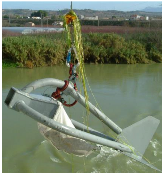
Figura 108. Muestreador Helley-Smith. Fuente. (IMTA, 2015)
