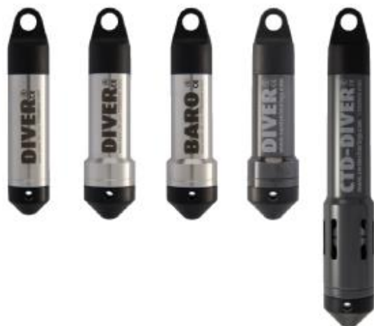
Figura 162. Sensores automáticos para medición de niveles- Diver. Fuente: (Maser, Productos de agua subterránea , 2015); (Schlumberger Water Services, 2014).
