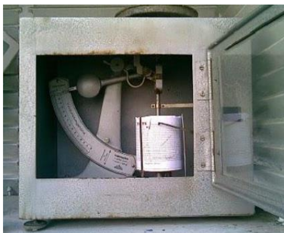
Figura 40. Izquierda: Esquema de evaporímetro tipo Wild. Tomado de (Ruiz Romera & Martínez Santos, 2015). Derecha: Evaporímetro tipo Wild. Tomado de: (Martínez, 2012).
