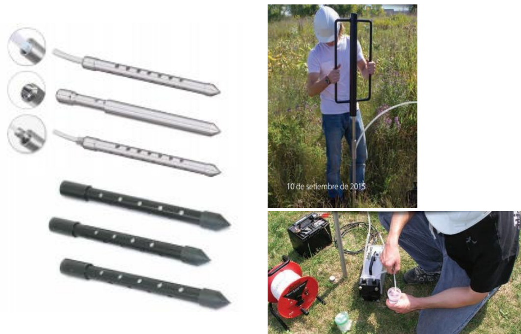
Figura 188. Tipos de piezómetros para hincar. Procedimiento de hincado de los piezómetros y toma de muestras. Fuente: (Solinst, 2017b).
