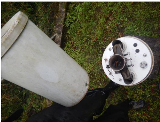
Figura 22. Pluviómetro de balancín utilizado en algunas estaciones del IDEAM. Fuente: Área Operativa 11-IDEAM 2017.
