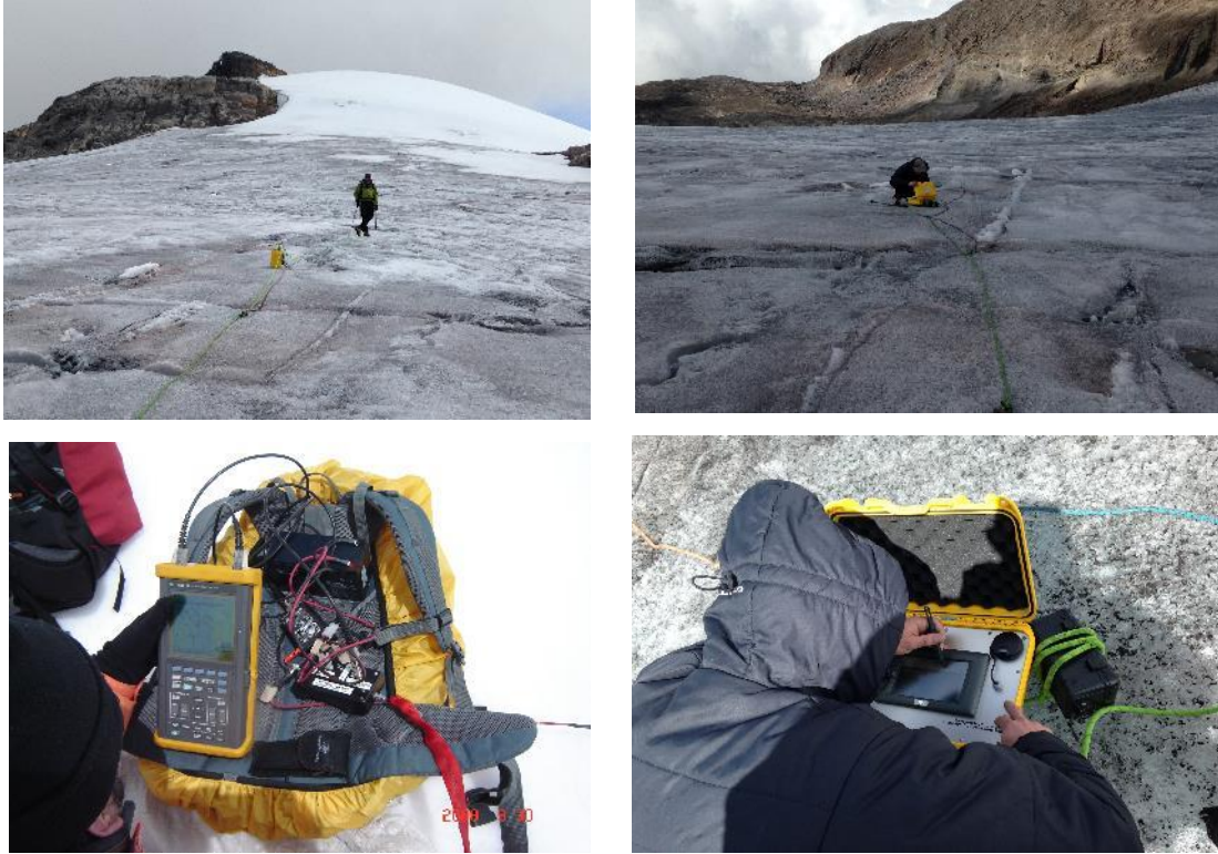
Figura 94. Transmisor utilizado para determinar el espesor del hielo, este envía una señal la cual será recibida por un receptor. Fotos de campañas de monitoreo de glaciares colombianos, IDEAM, 2014.
