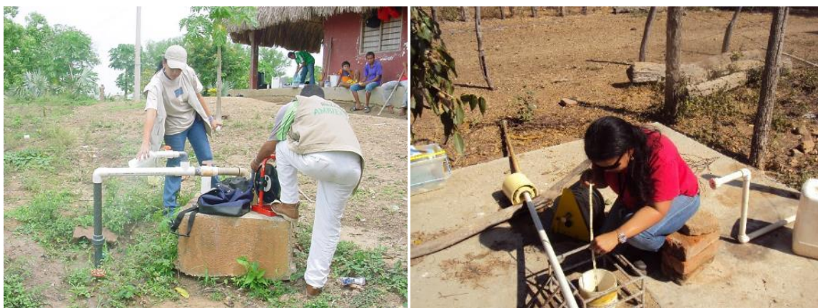
Figura 167. Medición de nivel piezométrico. Izquierda: Tolú, sucre. (Fotografía cedida por Carsucre, 2012); Derecha: Finca Las Delicias, Riohacha (Fotografía cedida por Corpoguajira, de campañas de monitoreo de enero de 2017)
