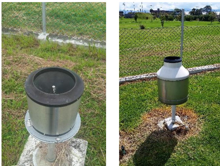
Figura 27. Pluviómetros digitales instalados en algunas estaciones meteorológicas del IDEAM. Izquierda: Pluviómetro Marca McVan Instrument- Derecha: Pluviómetro Marca MPS Systems. Fuente: Grupo de Automatización, 2017.
