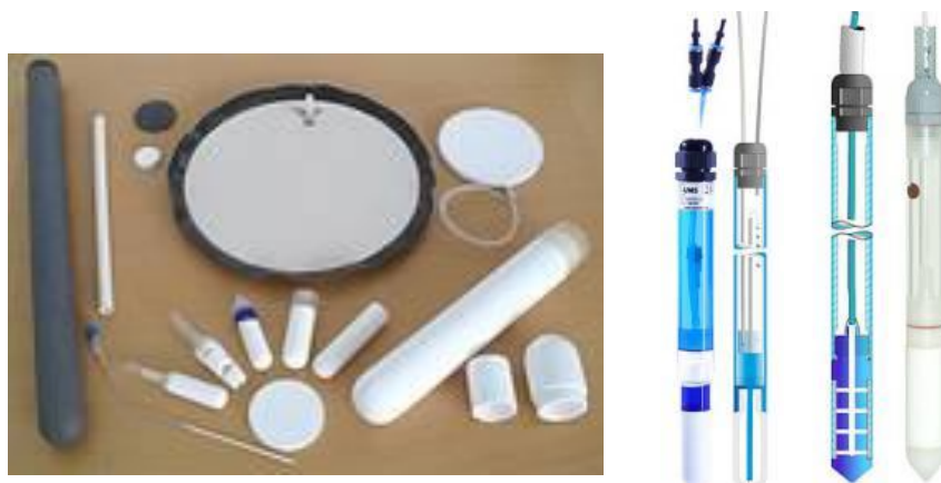
Figura 185. Copas de Succión para Muestreo de Agua del Suelo – Lisímetros. Izquierda: Copas de Succión (lisímetros) para el muestreo de agua del suelo para análisis químicos. Derecha: Muestreador de agua del suelo con almacenamiento del agua en el vástago.
