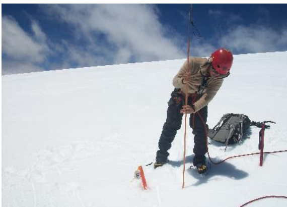
Figura 92. Captura de valores de espesor de nieve con el uso de una sonda para nieve. Fuente: Fotos de campañas de monitoreo de glaciares colombianos, IDEAM, 2012.
