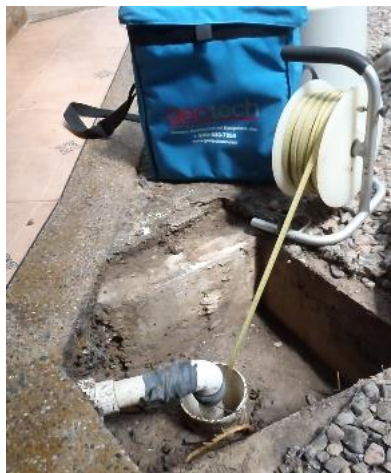
Figura 166. Izquierda: Monitoreo de niveles realizado en el Municipio de Puerto Gaitán. Fuente: (Cormacarena; SIAM S.A, 2016). Derecha: Esquema que ilustra la medición de niveles con el uso de una sonda manual (HYDROTECHNIK, s.f).
