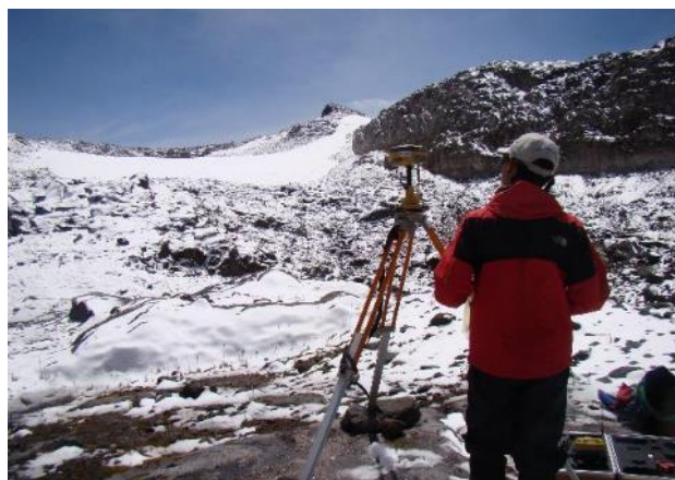
Figura 96. Levantamiento topográfico utilizando un equipo GNSS diferencial. Fotos de campañas de monitoreo de glaciares colombianos, IDEAM, 2017.
