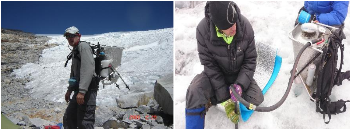
Figura 95. Izquierda: Detalle de perforadora Heucke. Derecha: Perforación de hielo empleando la perforadora Heucke. Fotos de campañas de monitoreo de glaciares colombianos, Sierra Nevada El Cocuy. IDEAM, 2008 y 2016.
