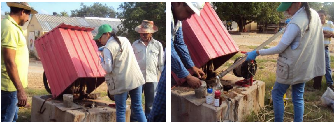
Figura 183. Muestreo en pozos profundos utilizando un bañilero. Información cedida por Corpoguajira de muestreo del pozo profundo Internado Aremasain- Riohacha, en campañas de muestreo de enero de 2017.
