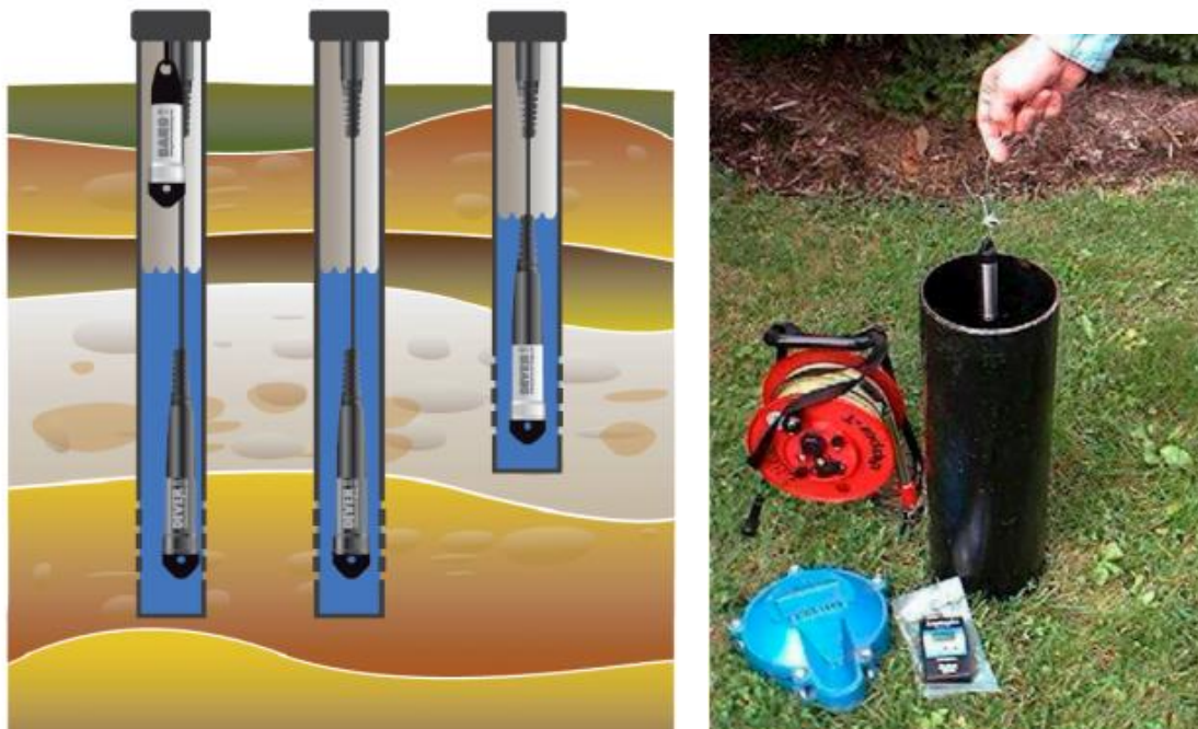
Figura 168. Medición de los niveles de agua subterránea utilizando un Diver. Izquierda, Fuente: (Schlumberger Water Services, 2014) ; Derecha, Fuente: (IDEAM, 2015).
