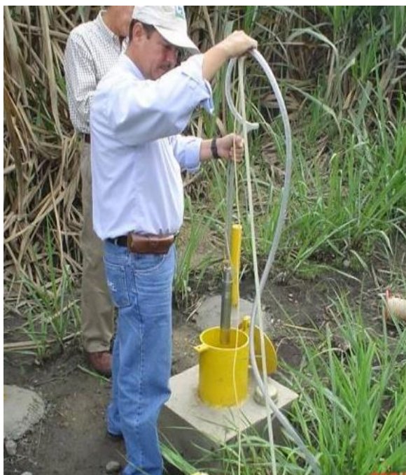
Figura 194. Muestreo de aguas subterráneas. Tomado de (CVC, 2009)
