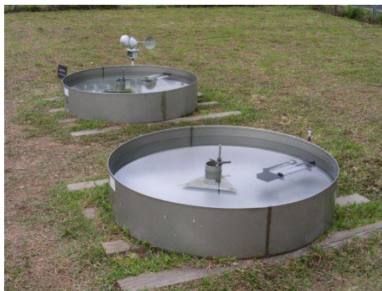
Figura 36. Detalles del tanque de evaporación. Se observa un termómetro flotante y un anemómetro situado cerca del tanque. Fuente: (Hong Kong Observatory, 2003)
