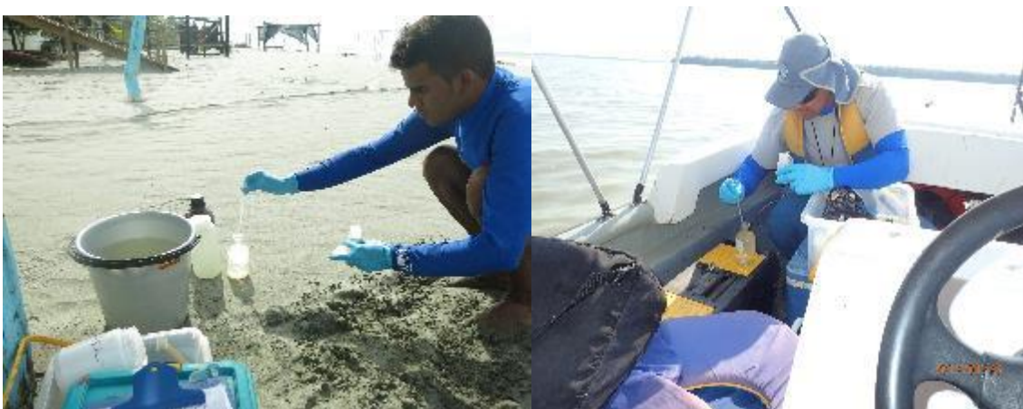
Figura 202. Preservación de muestras de agua en campo. Foto. Archivo INVEMAR.
