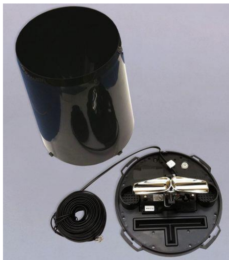
Figura 26. Detalle de un pluviómetro digital. Fuente: (Direct Industry, 2017)
