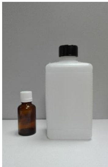
Figura 51. Frascos de muestreo isotópico de ^2\text{H} , ^{18}\text{O} y ^3\text{H} : frascos de 500 mL de polietileno de alta densidad y frascos de vidrio color ámbar de 30 mL, suministrados por la OIEA.
