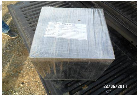
Figura 98. Empaque y rotulado para embalaje de la muestra inalterada en caja (1047538E - 1379080N). Fuente: Elaboración propia.
