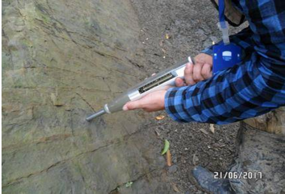
Figura 99. EG-09B sobre la margen derecha del río Currulao, sobre roca. Prueba con martillo Schmidt en lodolita meteorizada (1063309E – 1375915N). Fuente: Elaboración propia.
